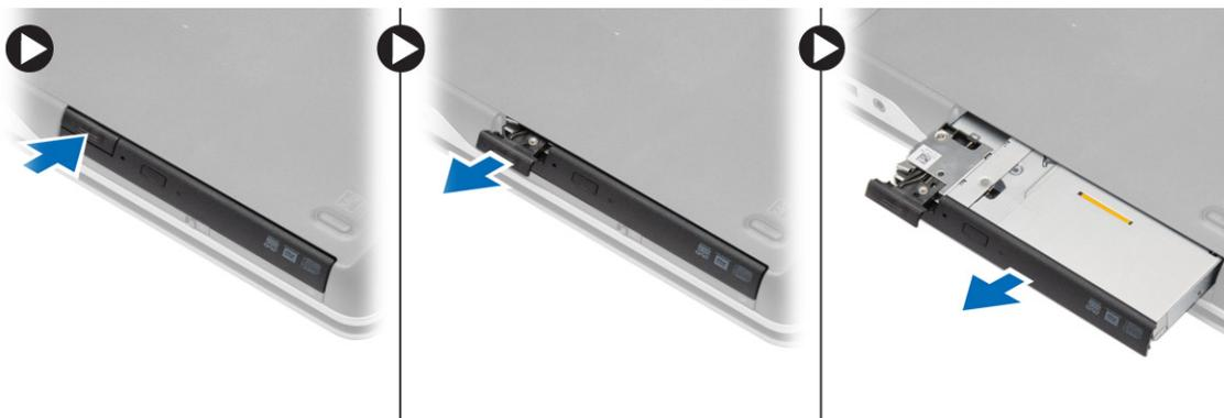
4. Extraiga el tornillo que fija el seguro de la unidad óptica a la unidad óptica. Deslice el seguro de la unidad óptica y sáquelo del ensamblaje de la unidad óptica.
