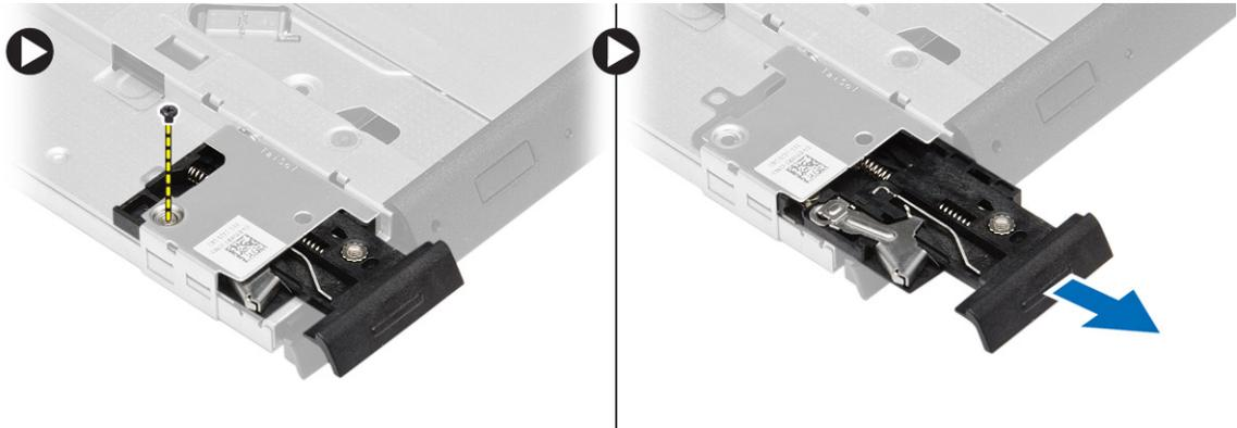
5. Extraiga los tornillos que fijan el soporte del seguro de la unidad óptica a la unidad óptica. Retire el pestillo del soporte de la unidad óptica.
