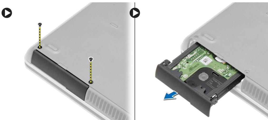
4. Extraiga el tornillo que fija la caja de la unidad de disco duro a la unidad de disco duro. Extraiga la caja de la unidad de disco duro de la unidad de disco duro.
