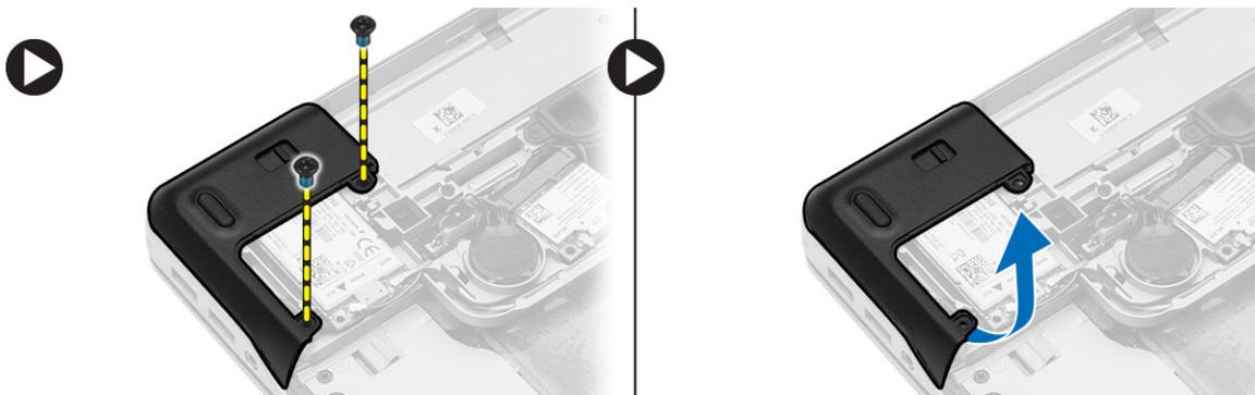
4. Extraiga los tornillos que fijan la tapa de la esquina de la base del extremo derecho, levántela y extráigala del equipo.
